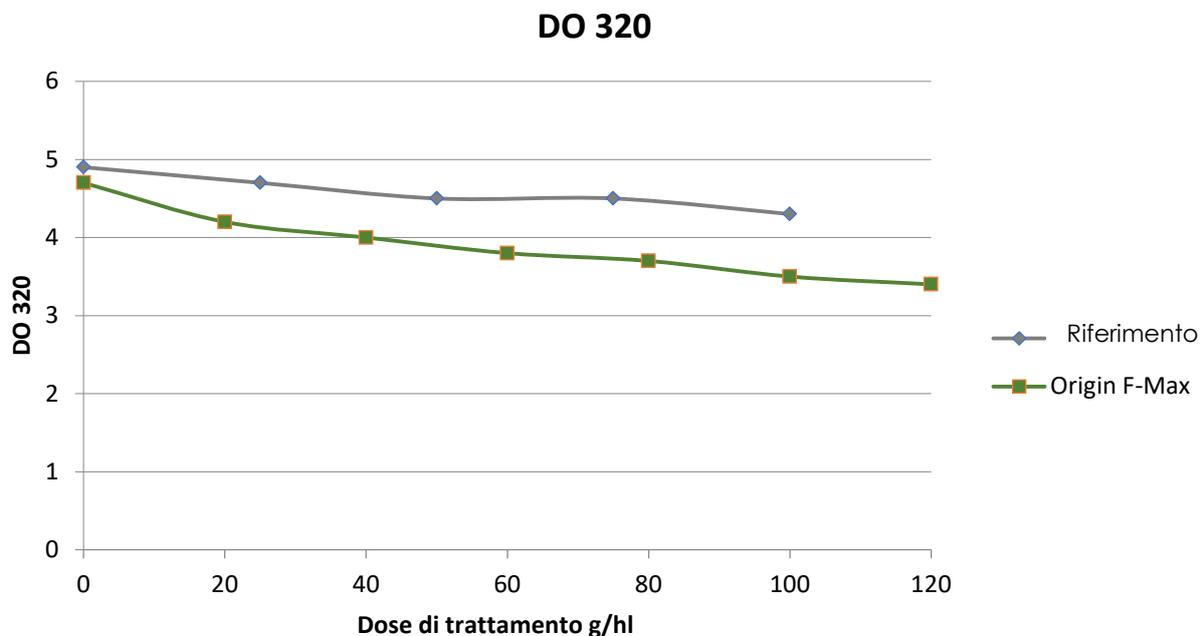
**Figura n°1:** Impatto di **ORIGIN MAX** sulla concentrazione in componenti ossidabili (DO 320)
